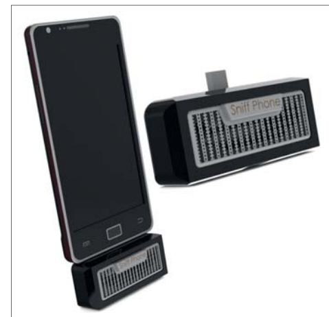
Рис. 4. Sniffphone project: облачные технологии и искусственный интеллект позволяют выявлять выдыхаемые метаболиты раковых клеток
