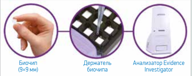
Рис. 9. Биочип и анализатор Evidence Investigator компании Randox для обнаружения SARS-CoV-2
