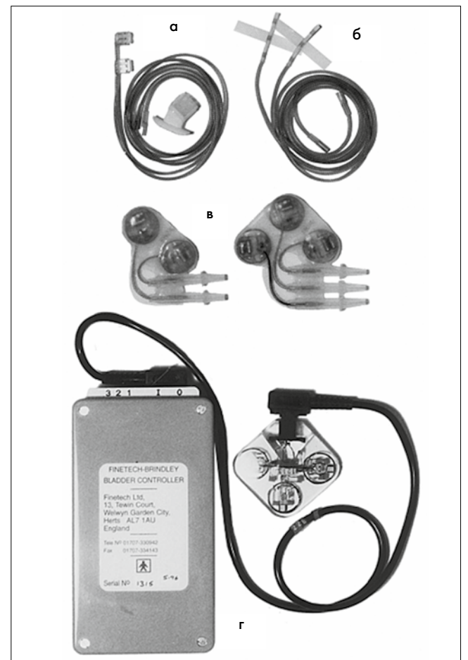
Рис. 24. Пристрій Finetech-Brindley компанії Finetech Medical Limited для проведення стимуляції передніх крижових корінців (SARS): а – інтрадуральні електроди та провід; б – екстрадуральні електроди та провід; в – дво- та триканальні імплантуєчі (під шкіру) радіочастотні приймачі; г – зовнішній пристрій із радіопередавачем [26, 27]
