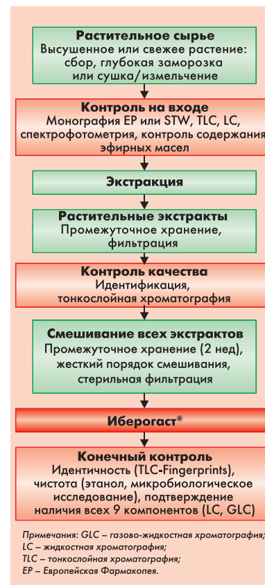
Рис. 2. Процесс производства препарата от растительного сырья до готового продукта (Kroll et al. Phytomed 2006; 13:12-19)
