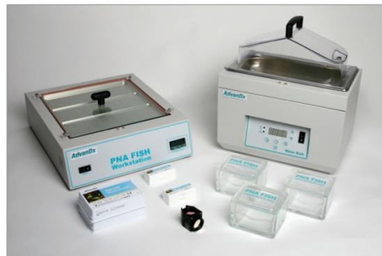
**Рис. 4. Аппарат для выявления возбудителя с использованием FISH-технологии**
