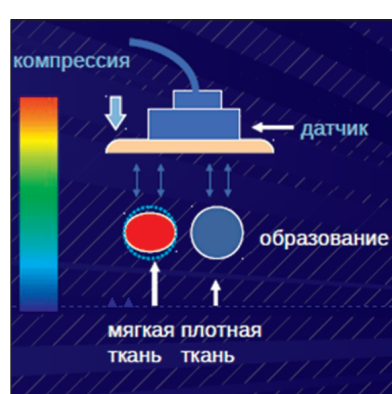
Рис. 4. Принцип статической эластографии
