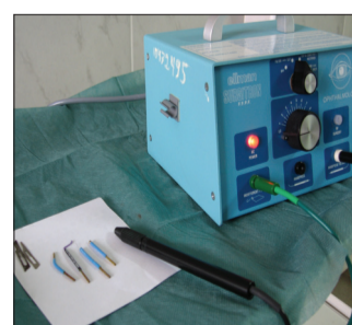
Рис. 7. Радиоволновой нож (выходная мощность – 140 Вт, выходная частота – 3,8 МГц, диаметр электрода – 0,4 мм)
