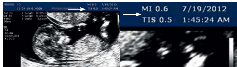
Рис. 1. В техническом поле дисплея УЗ-сканера рядом с индикацией даты и времени непрерывно отражаются показатели – MI и TI (стрелки). При работе в высокоэнергетических доплеровских режимах акушерских программ индексы не превышают предельно допустимых значений, безопасных для плода
