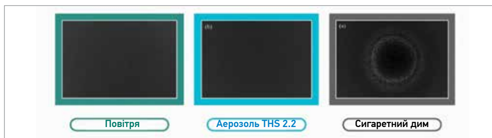
Рис. 4. Субмікронні частинки, зібрані після проходу аерозолу THS 2.2 (IQOS) і сигаретного диму (електронна мікроскопія; ліворуч – сканограма до початку збору аерозолу)
