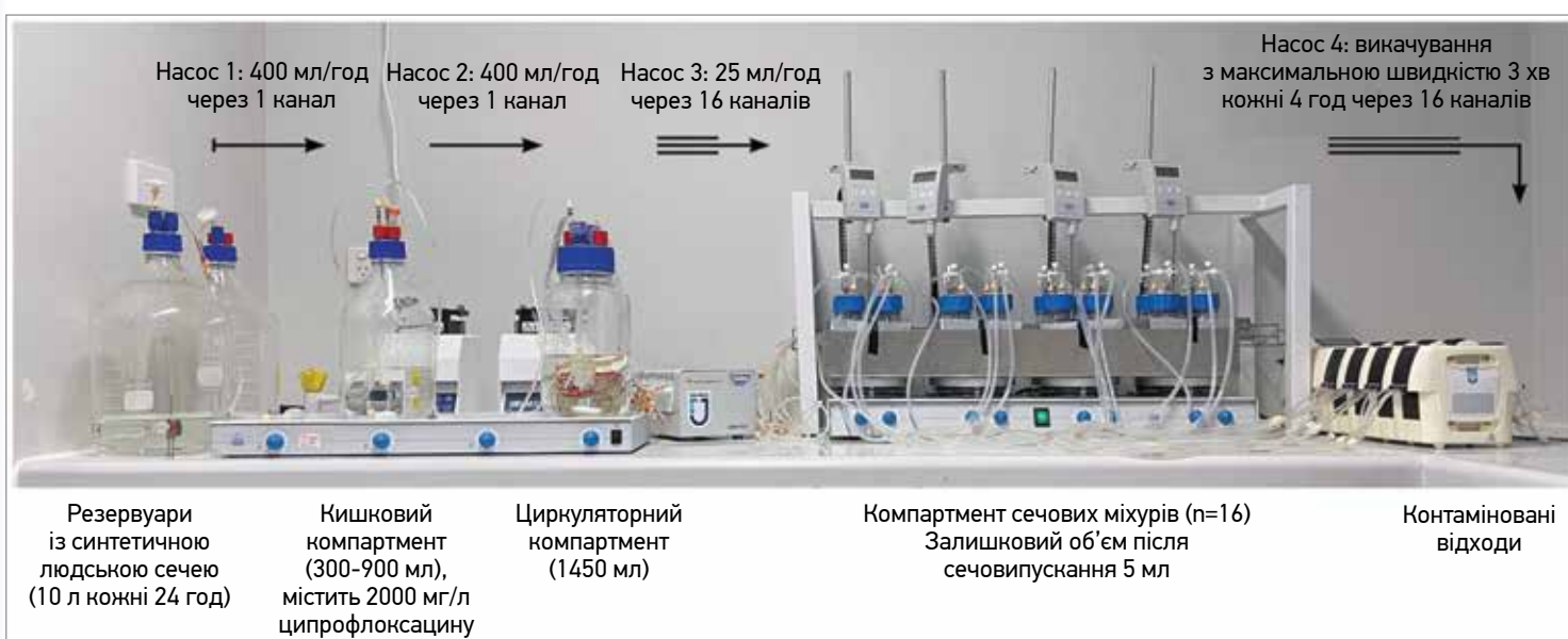
Рис. Загальний вигляд моделі ІСШ in vitro за принципом динамічного багатокамерного розведення, що використовується для моделювання експозиції ципрофлоксацину в сечі після перорального прийому
