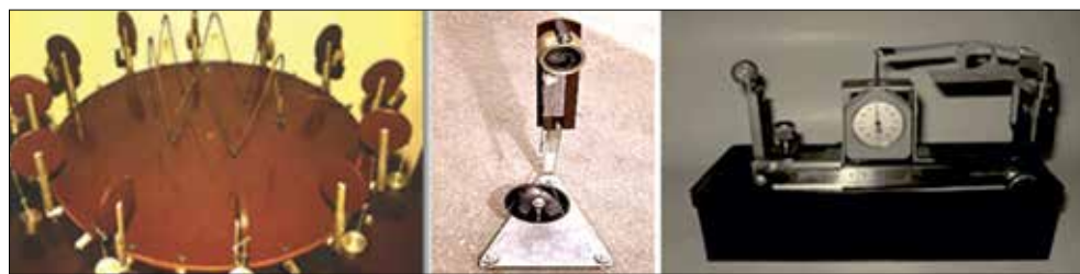
Фото 21. Оригинальные устройства для измерения радиального усилия фиксирующего элемента; справа – устройство, разработанное А.С. Неонетой
