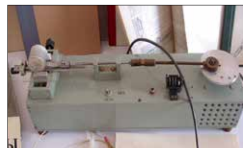
Фото 22. Оригинальное устройство для создания циклических нагрузок
