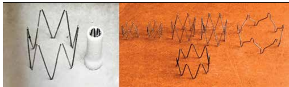
Фото 17. Один из первых фиксирующих элементов, разработанных и изготовленных в Харькове (слева), и последние стенты харьковской группы, включая нитиноловый (справа)
